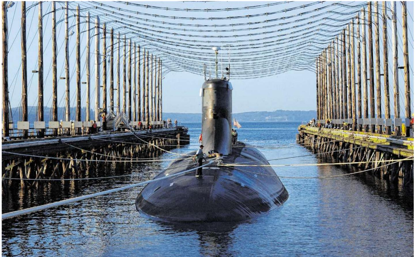
Hier auf diesem Beispielfoto des U-Boots USS Jimmy Carter sieht man die Leitungen für die Entmagnetisierung oberhalb – getragen von den Stangen aus Hartholz.
